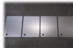
車両の疑似水平を出すために車輪タイヤ下に敷くプレート
