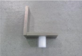
角度計を安定して設置するためのツール。
